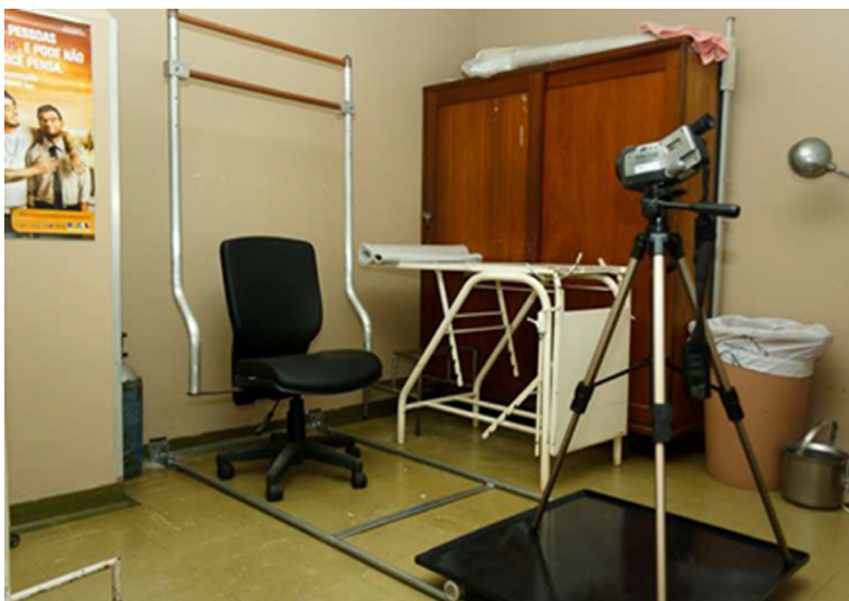
Figura 2: Aparato Mecânico para Padronização da Aquisição de Imagens Termográficas de Mama.
